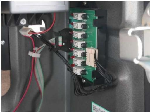
スロット台背面の穴から「スロット↔本体接続ケーブル」のベージュ色のコネクタを通し、リール横にある集中端子盤に挿し込んで下さい。
