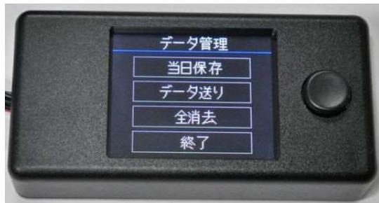
この画面で十字キーを押下すると選択カーソルが点滅し始めますので、十字キーの上下方向で当日データをセーブ、データ送り、全データ消去の3項目のいずれかを選択します。メイン画面に戻るには「終了」を選択し、カーソルの点滅を消してから十字キーを上方向に押下します。
